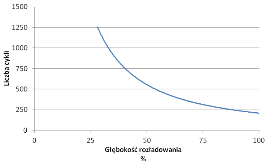
Rys. 17. Zależność trwałości akumulatora kwasowo-ołowiowego wykonanego w technologii AGM z przeznaczeniem do pracy buforowej (liczona w cyklach ładowanie-wyładowanie) od głębokości rozładowania [opracowanie własne na podstawie danych producenta akumulatorów SSB]
