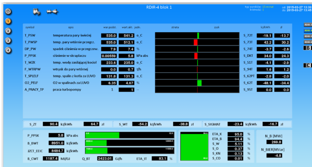
Rys. 1. Przykładowa mapa synoptyczna obrazująca wpływ podstawowych odchyłek produkcyjnych na koszty wytwarzania, pochodząca z Systemu Technicznej Kontroli Eksploatacji metodą TKE® (autorski system „ENERGOPOMIAR” Sp. z o.o.) służącego do monitorowania i kontroli eksploatacji bloków energetycznych
