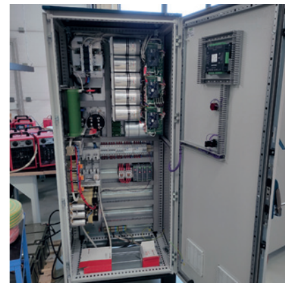
Rys. 10. Układ przekształtnikowy dla mikrobiogazowni z prądnicą indukcyjną o mocy 20 kW
