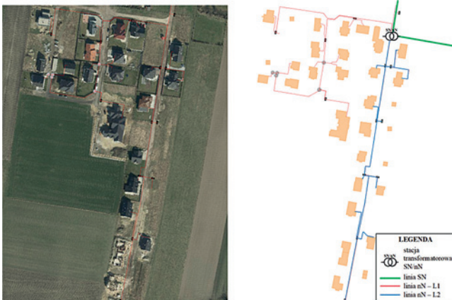
Rys. 5. Przykładowy schemat sieci z danymi geolokalizacyjnymi – dwie linie nN podłączone do stacji transformatorowej SN/nN
