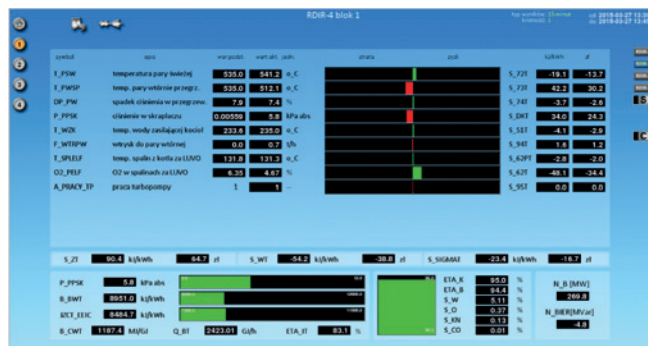
Rys. 1. Przykładowa mapa synoptyczna obrazująca wpływ podstawowych odchyłań produkcyjnych na koszty wytwarzania, pochodząca z Systemu Technicznej Kontroli Eksploatacji metodą TKE® (autorski system „ENERGOPOMIAR” Sp. z o.o.), służącego do monitorowania i kontroli eksploatacji bloków energetycznych Źródło: opracowanie własne
