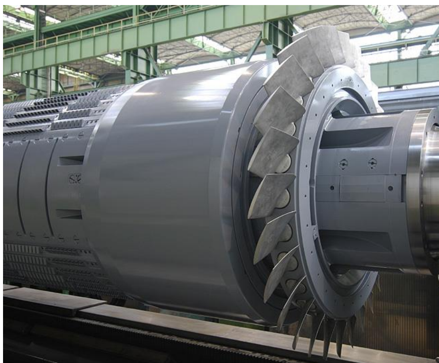
Rys. 3. Wirnik turbogenerators z zabierakowymi klinami żłobkowymi i nowym wentylatorem osadzonym na wale
