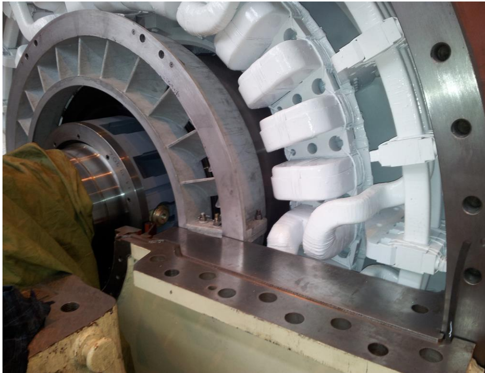
Rys. 6. Nowa osłona wentylatora wirnika z tylnymi łopatkami kierowniczymi
