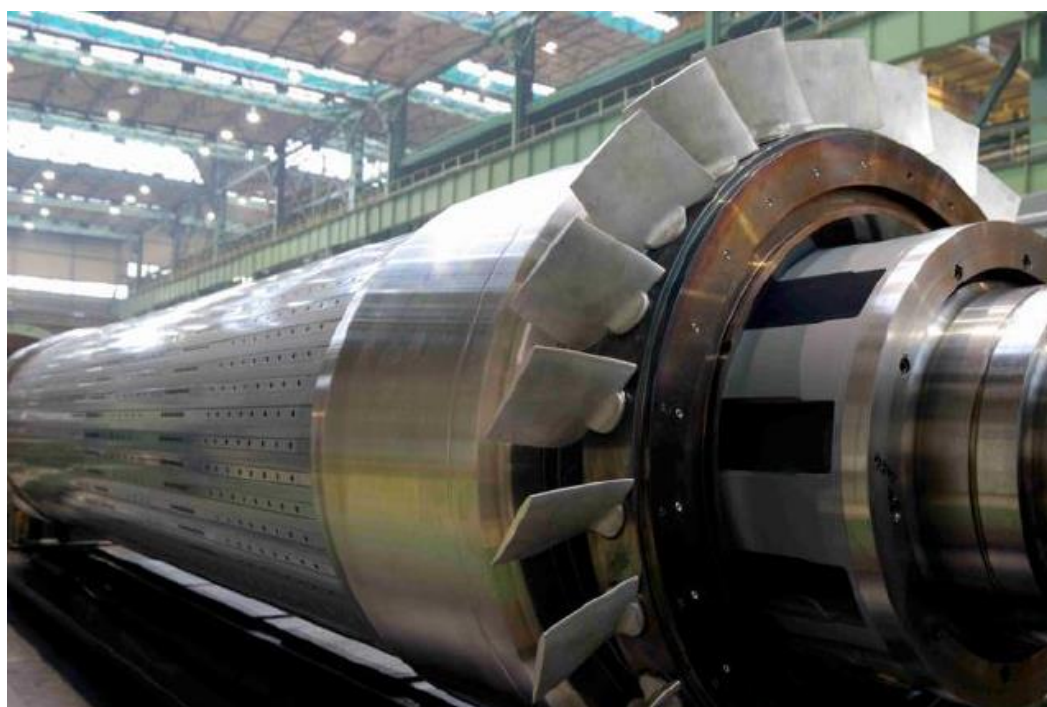
Rys. 5. Nowy wentylator zabudowany na wale wirnika
