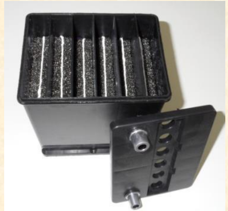
Nowy akumulator, masa elementów konstrukcyjnych 0,5 kg.
