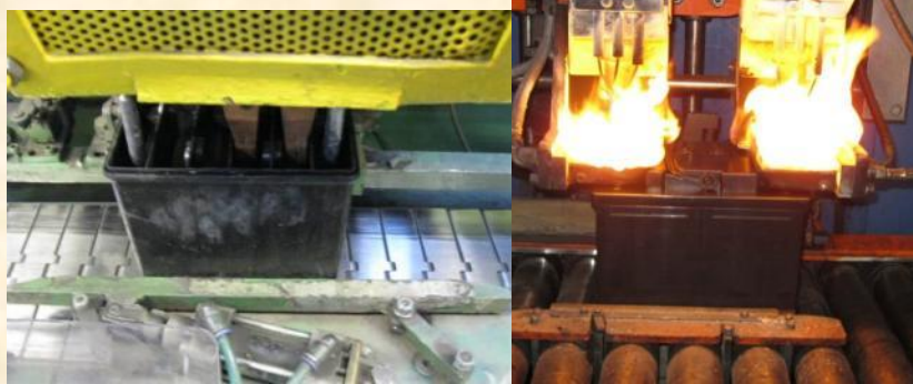
Zgrzewanie cel na zgrzewarce opornościowej
