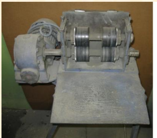
Koperciarka wykonana do sezonowania płyt węglowych.
