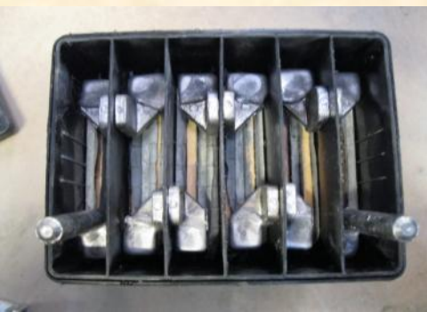
Zestawy płyt z górnym ołowiem umieszczone w bloku
