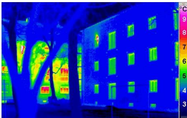
Ilustracja 1. Termogram - ciemne kolory obrazują mało ciepła oddaje dom pasywny (po prawej) porównaniu z domem typowym (po lewej) 7
