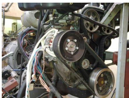
Rys. 2. Widok maszyny Smart Hybrid połączonej z wałem korbowym silnika spalinowego
