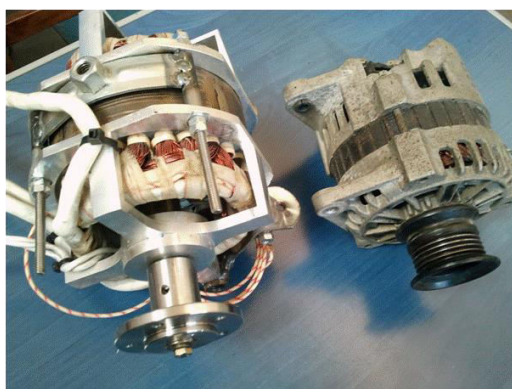
Rys. 1. Porównanie gabarytu maszyny PMBLDC Smart Hybrid (widok z góry) z typowym alternatorem 12V
