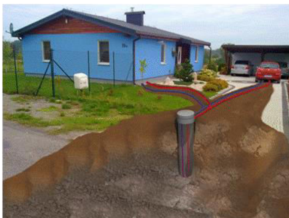
Rys. 8. Centralny zasobnik ciepła, który może być zainstalowany po wybudowaniu domu
