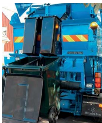
FOT. 9. ŚMIECIARKA PRZYSTOSOWANA DO POJEMNIKÓW WIELOFRAKCYJNYCH 5
