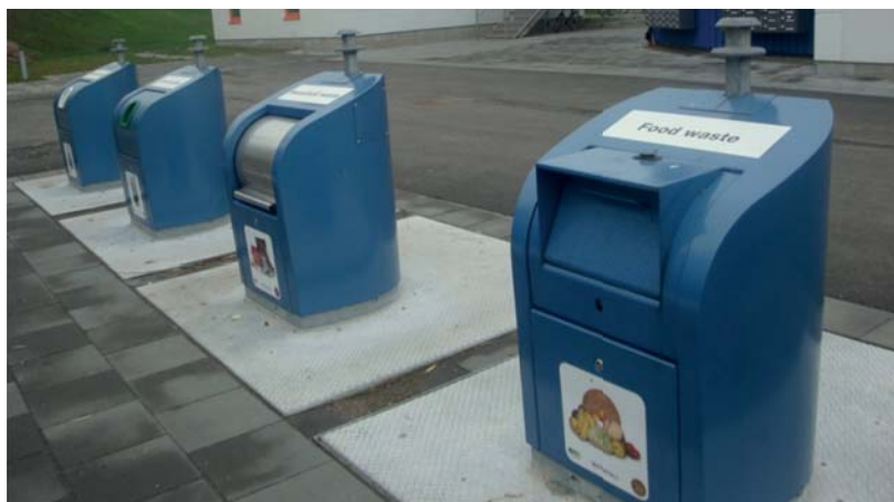
FOT. 3. SYSTEM PODZIEMNYCH ZBIORNIKÓW W LUND (FOT. M. ROGULSKA)
