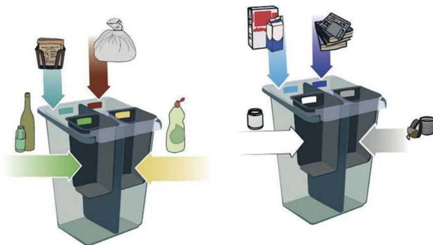
RYS. 2. POJEMNIKI WIELOFRAKCYJNE DO SEGREGACJI ODPADÓW „U ŹRÓDŁA”: POJEMNIK 1: ODPADY MIESZANE, ODPADY KUCHENNE (ŻYWNOŚCIOWE), KOLOROWE SZKŁO, PLASTYK; POJEMNIK 2: PAPIER, KARTONY, SZKŁO BIAŁE, METAL
