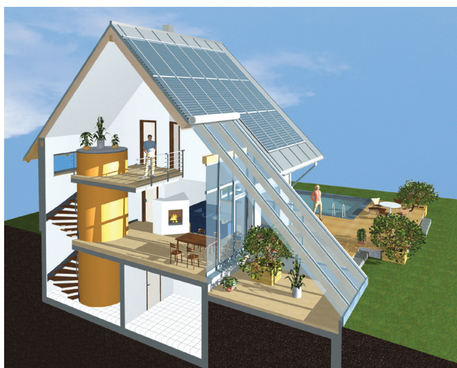
5. Zabudowany magazyn ciepła w domu słonecznym pełni funkcję potężnej kolumny przy klatce schodowej. Źródło: Sonnenhaus Institut
