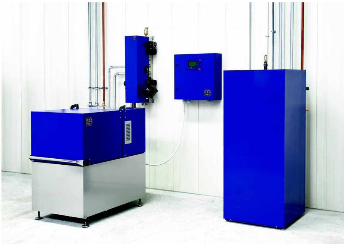
Rys. 4. Zestaw gazowej mikrokogeneracji MCHP XRGI – (od lewej: jednostka kogeneracyjna, dystrybutor ciepła, skrzynka przyłączeniowa z panelem sterowania, zbiornik magazynujący ciepło) [9].
