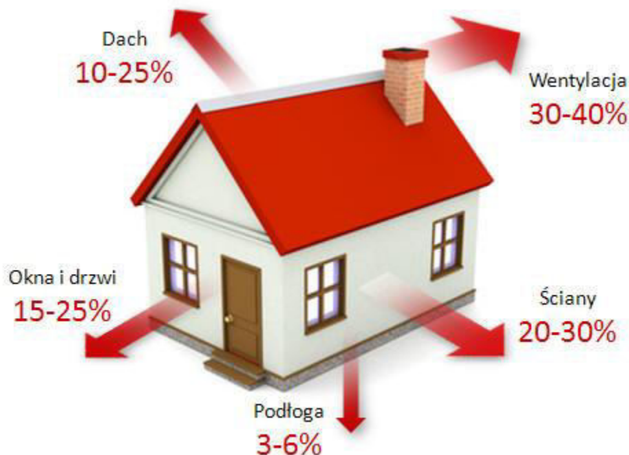
Rys. 5. Udział procentowy źródeł strat ciepła w budynku jednorodzinnym
