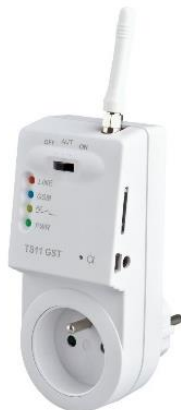
Rys. 18. Gniazdo wtykowe jednofazowe, sterowane m.in. sygnałem wifi
